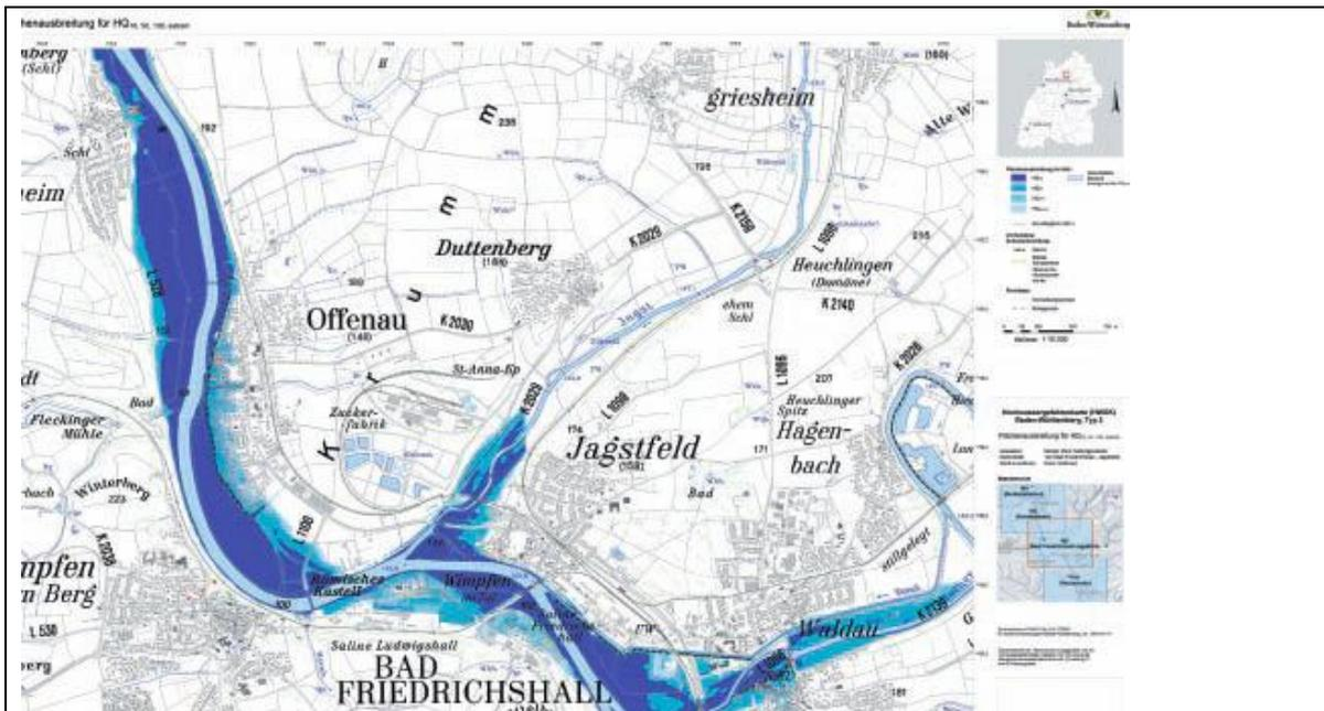
Abb. 3.5.7: Beispiel einer Hochwassergefahrenkarte – Darstellung der Flächenausbreitung der Überflutung bei HQ10 – HQ50 - HQ100- HQextrem (Maßstab 1:2.500)
